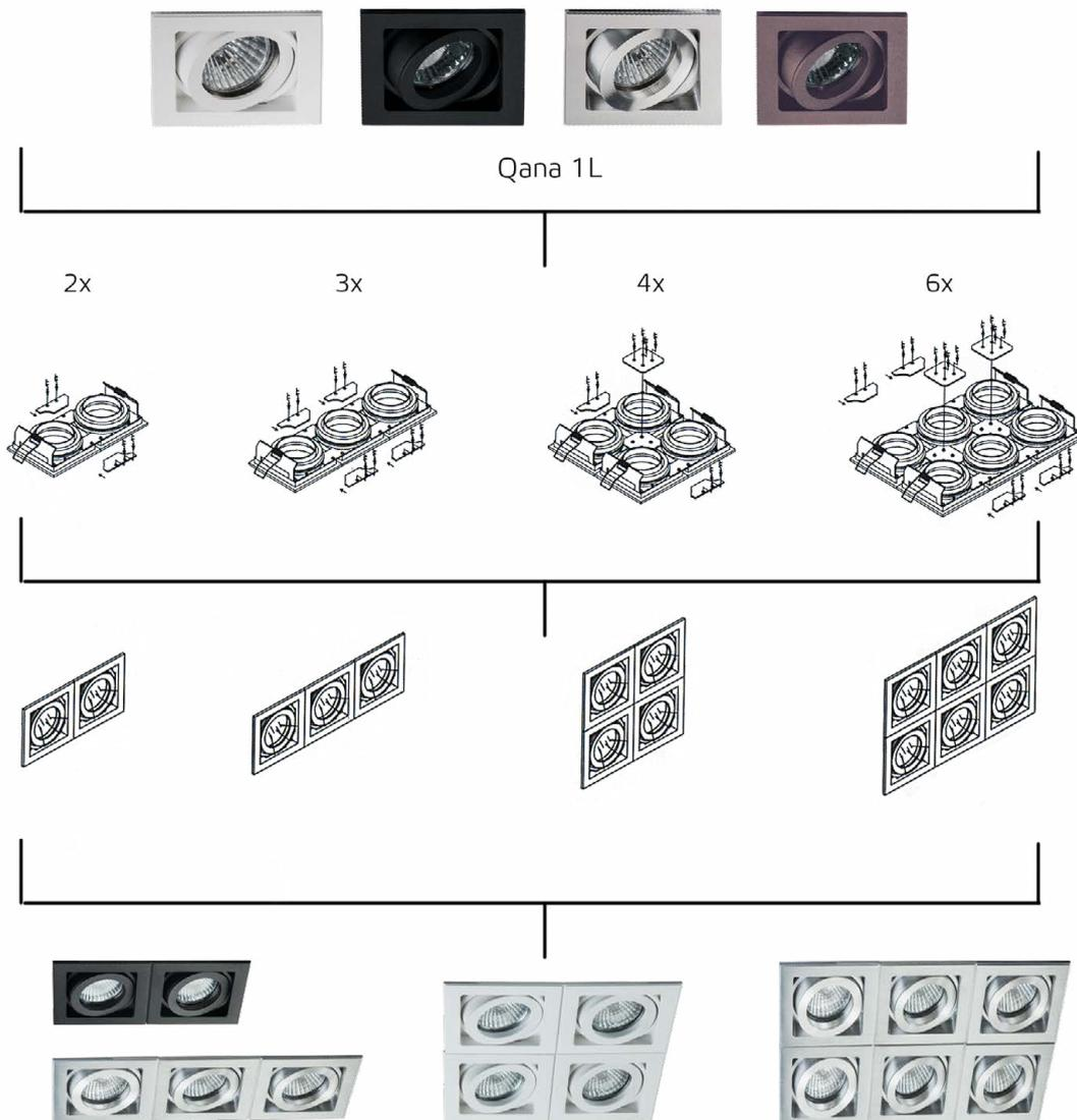
Схема возможных соединений для светильников DY 1681
