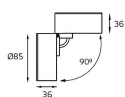
НАКЛАДНЫЕ ПОТОЛОЧНЫЕ СВЕТИЛЬНИКИ С ВОЗМОЖНОСТЬЮ КРЕПЛЕНИЯ
