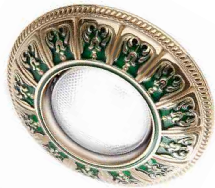
Art.1816/LU/VERDE ø est 100 mm ø int 53 mm ø foro per incasso 65 mm completo di molle - with screws
