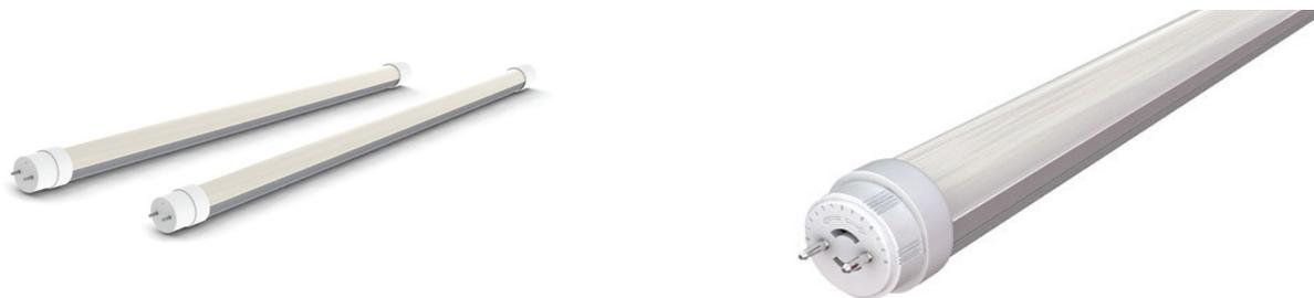
**Применение:** заменяют люминесцентные лампы в стандартных светильниках типа ЛСП и ЛПО, а так же растровых светильниках для потолков «Армстронг». Для подключения не требуют ЭПРА, дросселя и стартера, подключение производится напрямую к сети 220 В.
