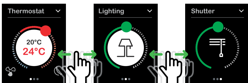
Переключение между основными функциями и их выбор осуществляются через сенсорный экран
