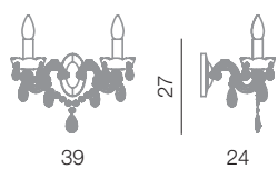
Vienna Plus parete 2L L 39 cm - H 27 cm - SP 24 cm 2 x E14 40W
