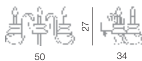
Miró parete 3L L 50 cm - H 27 cm - SP 34 cm 3 x E14 40W
