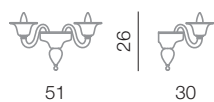
Barena parete 2L L 51 cm - H 26 cm - SP 30 cm 2 x E14 40W
