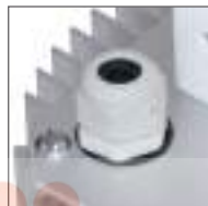
Герметичный кабельный ввод PG13,5 IP65 для кабеля диаметром от 6 до 12 мм
